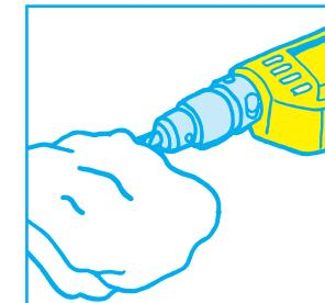
少し厚い板だとビットの先端が加熱して周囲を溶かしてしまって正確な穴あけができません。したがってプラスティックの場合は少しあけては中止し、水でぬらしたボロ布でビットを冷やしてまた始めるようにしていきます。ビットは金工用を使います。
