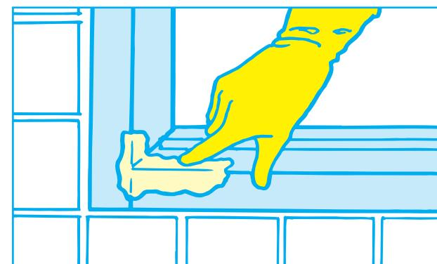
※ウッドエポキシは2液に別れていますので、ビニール手袋をした手で同じ量を練り合わせ、指でしっかりと腐蝕した部分に埋めていきます。
