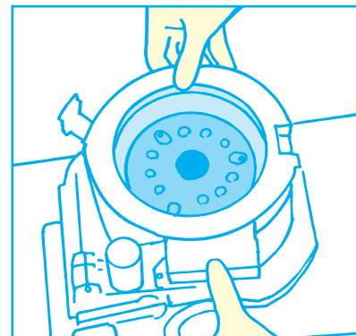
芯の出る寸法が狂わないように元通りにセットしてください。案内筒を固定するときには芯部分のすき間が均一になるようにしてください。
