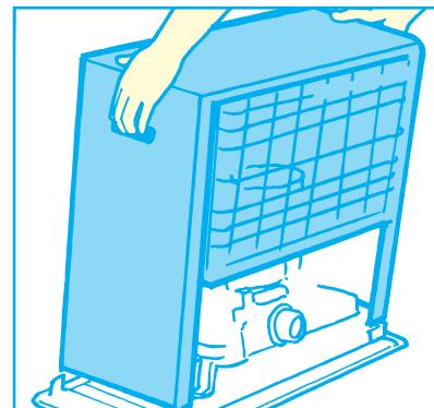
最初に燃焼筒を取りだした後、前板をはずしてください。そして給油タンクを出してから、側面のネジをはずしてキャビネットをはずします。
