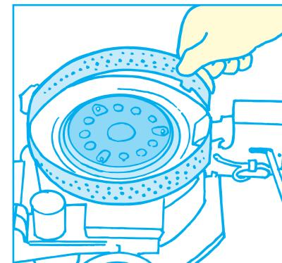
案内筒リングはバネ部分を上に引くとはずれます。点火装置もネジをはずして、静かに持ち上げて取りはずします。
