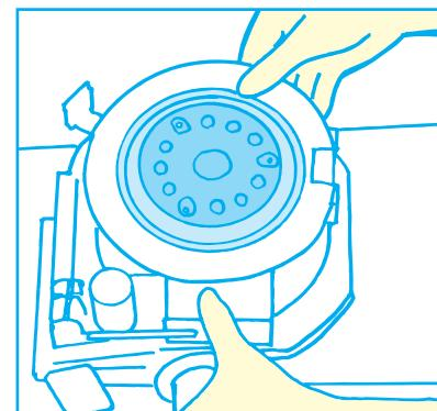
芯案内筒を固定しているネジをはずし、芯案内筒を取りはずし、中にある芯をはずしてください。
