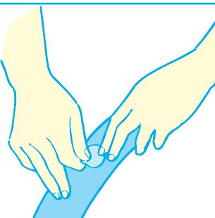
7 チューブのバルブ部分をタイヤに入れ、リムにナットで止めます。そしてバルブの本体を差しこんで空気を少し入れます。
