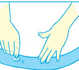
6 パンク部分の周辺にゴム系接着剤を薄く塗ります。そしてパッチゴムを適当な幅に切って、約3~5分待ちます。指でさわってもべつからくなつてからパッチゴムの裏のクロスを取ってパンク部分に貼り、かなづちで軽くたたいて密着させてください。そしてその部分にチョークの粉かベーパウダーをかけておいてください。そうすると接着剤がはみ出していてもチューブがタイヤにくっつきません。
