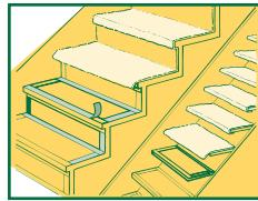
階段の幅、けこみ板から段板、下端いっぱいまでの寸法を正確に測ります。そしてパンチカーペットをそのサイズに断裁します。巻きぐせを直して広げ、傷がつかないように下敷きを敷いて定規を当てながら大型カッターで切ってください。
