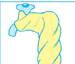
2 むきだしになっている部分を、冷凍食品の配送等に使われる発泡スチロールで囲み、ひもで縛りつけておくだけでも、寒風を避けることができますので、ある程度の効果があります。
