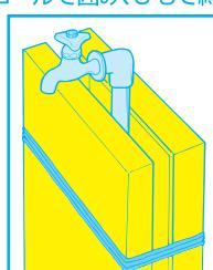
3 専用の保温材(パイプカバー、スチロールカバー、パイプガードカバー等)でカバーして、保温テープで巻きつけてください。配管の曲がっている部分には専用の保温材(エルボカバー・チーズカバー)もあります。
