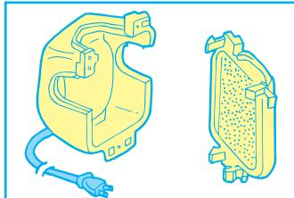
2. ケースのフタのネジ穴から付属のネジを通して、ネジを締めます。(ケースの本体とケースのフタがきちんとしまっていないと、凍結防止の効果が低くなりますので、しっかりとネジを締めるようにしてください)
