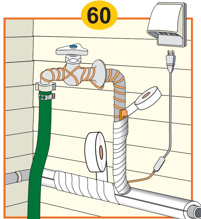
水は凍ると体積が増えます。真冬に急に冷えこんだりすると水道管の中にある水が凍り、体積が増えた分水道管の中から圧力がかかり、悪くするとヒビが入ります。それがお昼頃、少し暖かくなると凍った水が解けだして、はじめて水道管に亀裂が入っていることに気づき、大あわてという、毎年どこかで見かける光景になります。水があふれる傾外出して、帰ってみると水浸し、という悲劇もたまに耳にしますが、こんなときに凍結を防止する策を講じておけばよかったですのにと、つくづく思います。凍結防止をしておけば、水道管も破裂することはありませんし、冷たい真冬の朝でも水やお湯が使えます。いろいろな凍結防止の方法を紹介しますので、役に立ててください。
