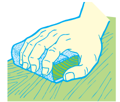
平面の場合は木片に巻きつけて磨きます。
