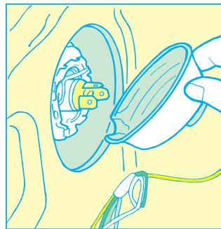
②防水用のゴムカバーは押しこんであるだけですので、簡単にははずれます。あけると電球(バルブ)を固定しているバネがあるので、引っかかりをはずしてください。
