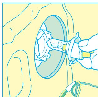
③バルブのソケットの部分を持って引き出し、3本のツメの位置が元通りであることを確認しながら、バルブを交換してください。組み立てははずしたのとは逆の順序で。
